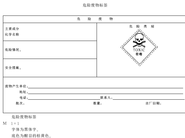
图 5.5-2 危险废物固体废物堆场标示图例
