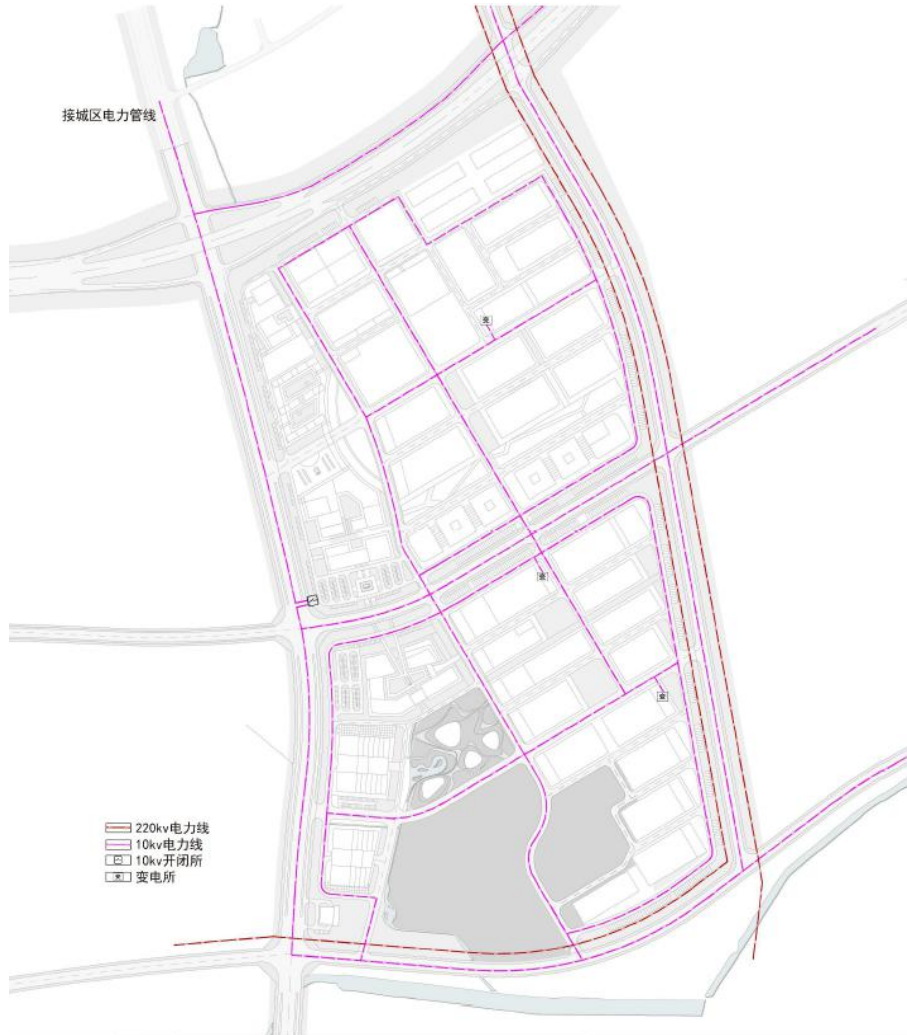
图 2.1-7 产业园区电力规划图
