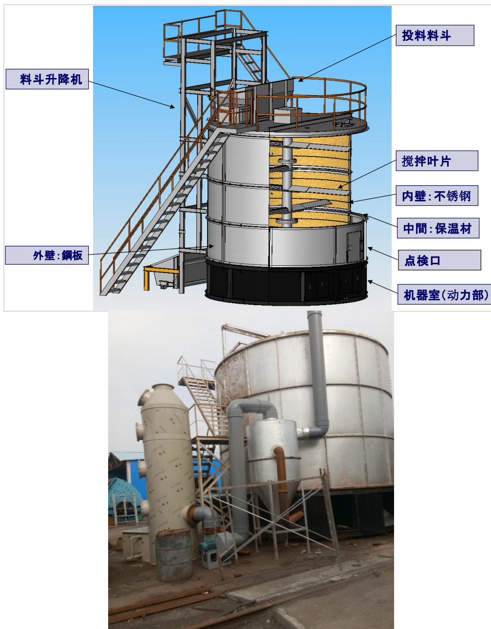
图 4.2-6 有机肥生产装置示意图
