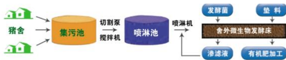
图 3.1-1 猪粪肥料化利用流程图
