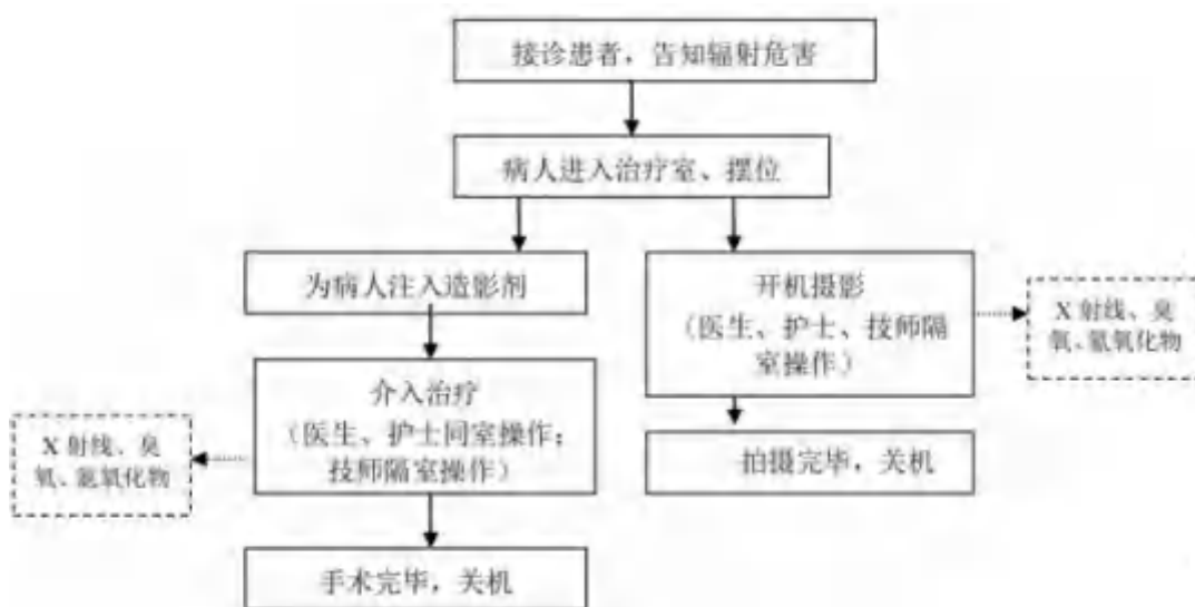
图 9-3 DSA 介入手术操作流程及产污环节示意图
