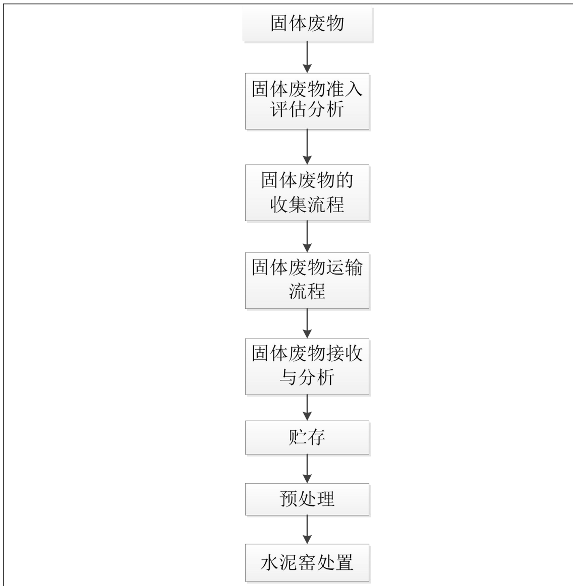
图 2.7-1 水泥窑综合利用危险废物流程图
